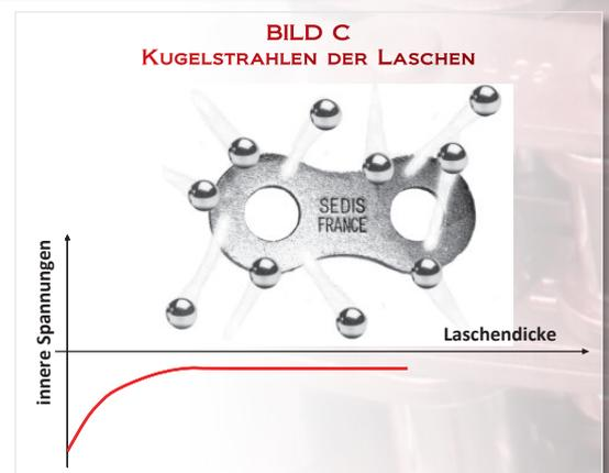
Dank sorgfältiger Materialwahl, der Wärmebehandlung und des Kugelstrahlens haben unsere ALPHA *Premium* und DELTA HR Ketten eine um durchschnittlich 20 % höhere Bruchkraft als die von der ISO Norm geforderten Minimalwerte. Die Performance hinsichtlich Schockwiderstand und Dauerfestigkeit ist DEN BESTEN AM MARKT BEFINDLICHEN KETTEN ÜBERLEGEN.
