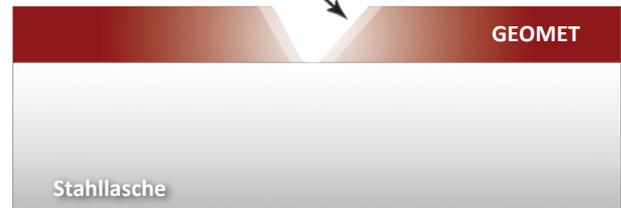
Im Salzsprühetest beweist die GEOMET® Beschichtung der DELTA® TITANIUM 2 Ketten eine überzeugende Korrosionsbeständigkeit. Rost tritt erst nach 450 h auf, während dies bei verzinkten/chromierten Teilen bereits nach 100 h eintritt (siehe unten).
