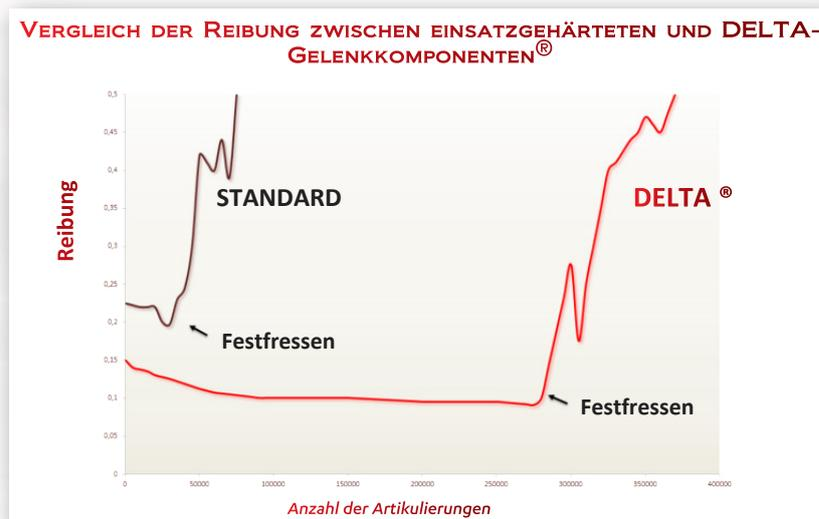
Dank der größeren Oberflächenhärte, dem niedrigeren Reibfaktor und einer kompatiblen chemischen Affinität, bieten die Ketten DELTA® HR **eine längere Lebensdauer**, insbesondere bei schwierigen Einsatzbedingungen (Abrieb, Forderung nach eingeschränkter Kettenlänge).
